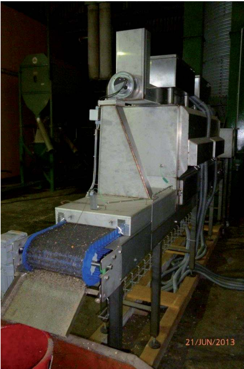
Abbildung 4: Produktabführung mit Temperaturmessung
